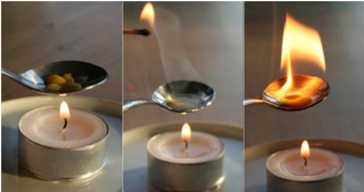
Bild 6: Der Wachsdampf, der sich über der Kerze bildet, lässt die Flamme brennen.
